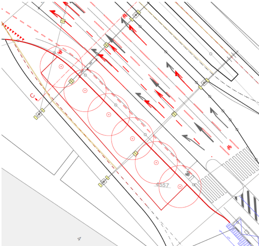
Abbildung 12: Zulauf Mingerstrasse mit neuer Baumreihe, Ausschnitt Situationsplan
